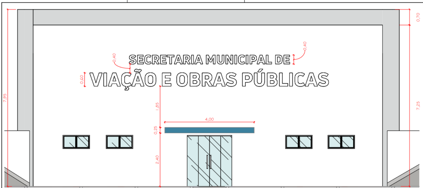
1 DETALHAMENTO DE FACHADA (LETREIRO E MARQUISE)
