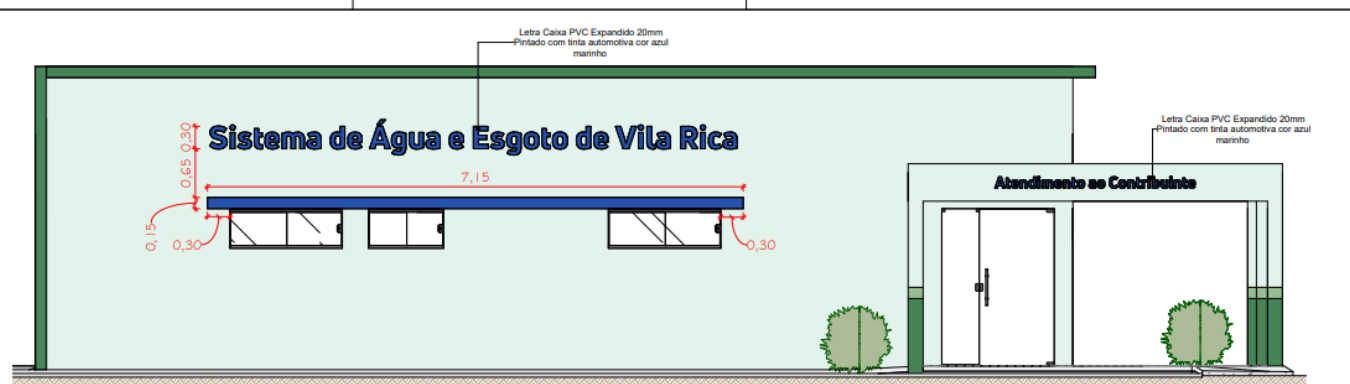
1 DETALHAMENTO DE FACHADA (SAEVIR) 1 : 50
